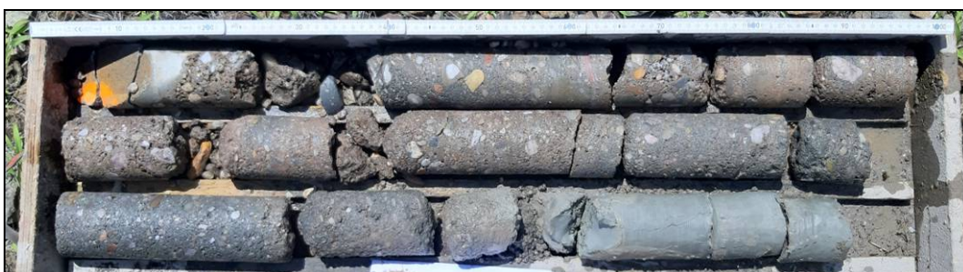
Obr. č. 4 - diagnostický vrt Š2 do dřívku zdi - v km 245,651
