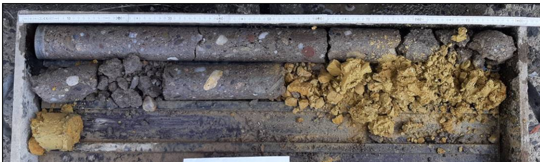
Obr. č. 1 - diagnostický vrt V1 do dřívku zdi - v km 245,680
