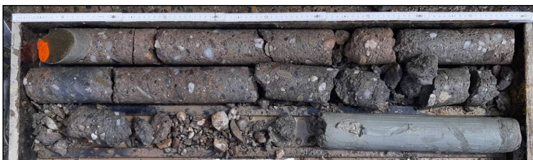
Obr. č. 2 - diagnostický vrt Š1 do dřívku zdi - v km 245,680
