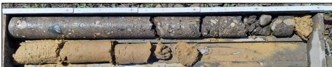
Obr. č. 3 - diagnostický vrt V2 do dřívku zdi - v km 245,651
