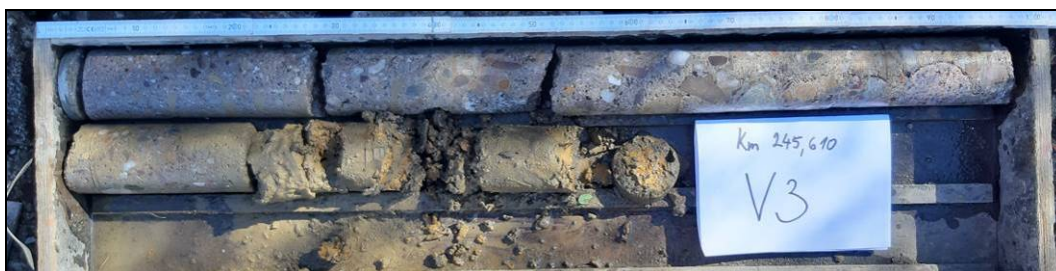
Obr. č. 5 - diagnostický vrt V3 do dříku zdi - v km 245,610
