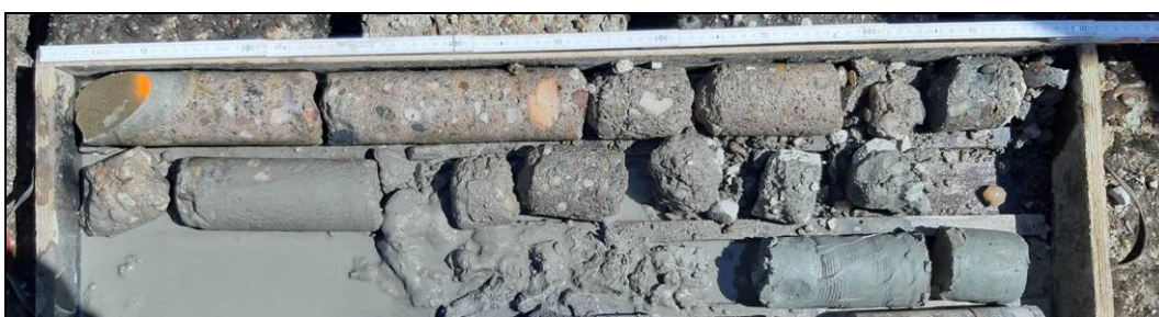
Obr. č. 6 - diagnostický vrt Š3 do dříku zdi - v km 245,610
